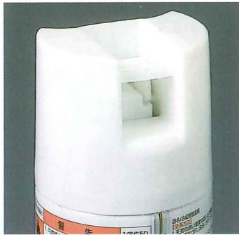
レバーを押し込むと「プシュ」と音がして、中の硬化剤入り容器に穴があき、硬化剤が容器内に噴出されます。(塗料が噴出してもよいように噴出口部分をウェスおよびビニール袋などでおおってください。)
